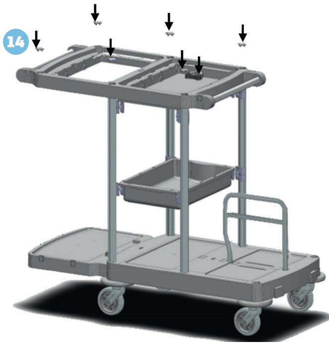
SETZEN SIE DIE 6 SCHRAUBENABDECKUNGEN UND DIE HALTERUNG FÜR DEN BEFESTIGUNGSGRIFF IN DIE ENTSPRECHENDEN SCHLITZE EIN.
