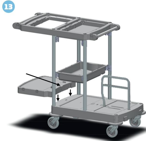
1. VERRIEGELN SIE DIE SACKHALTERUNG DURCH DREHEN DES ZENTRALSLÜSSELS UM 90°. –
