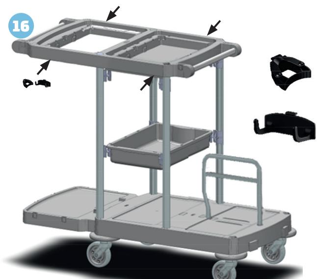
ENTFERNEN SIE DIE ABDECKUNGEN AN ZWEI BELIEBIGEN POSITIONEN MIT EINM SCHRAUBENDREHER. SETZEN SIE DIE GERÄTEHALTERUNG UND DEN HAKEN AN EINE DER POSITIONEN.
