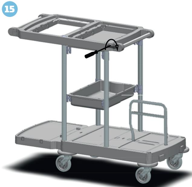
SCHRAUBEN SIE MIT EINEM KREUZSCHLITZ-SCHRAUBENDREHER DIE ZENTRALE SCHRAUBE DER GRIFFHALTERUNG.
