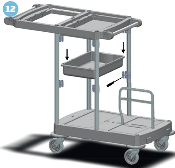
DIE SCHALE IN DER GEWÜNSCHTEN POSITION ANBRINGEN UND DIE SEITLICHEN SCHRAUBEN DER STÜTZEN MIT EINEM KREUZSCHLITZ-SCHRAUBENDREHER FESTZIEHEN.
