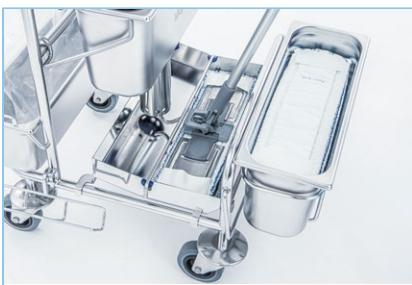
STEP 4: Bügel in der Wanne mit dem Mopphalter nach unten drücken und gleichzeitig mit dem Mopp Flüssigkeit aufnehmen. Durch Anheben des Mopphalters wird die Flüssigkeit wieder vordosiert.
