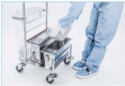
STEP 2: Mopp (10 - 12 Stück) mit dem Deckblatt nach oben in die Systembox EasyMop GMP® einlegen.
